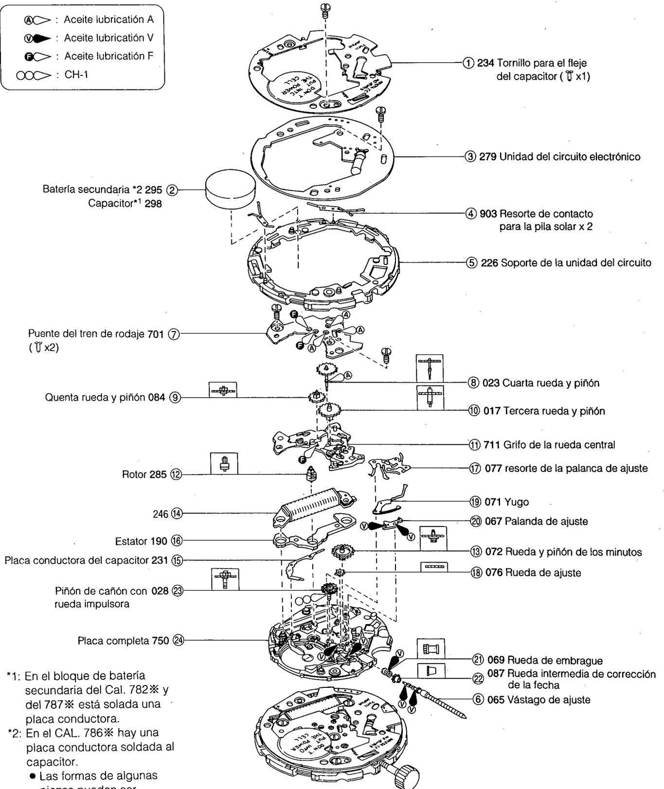
\*1: En el bloque de batería secundaria del Cal. 782\* y del 787\* está solada una placa conductora.
